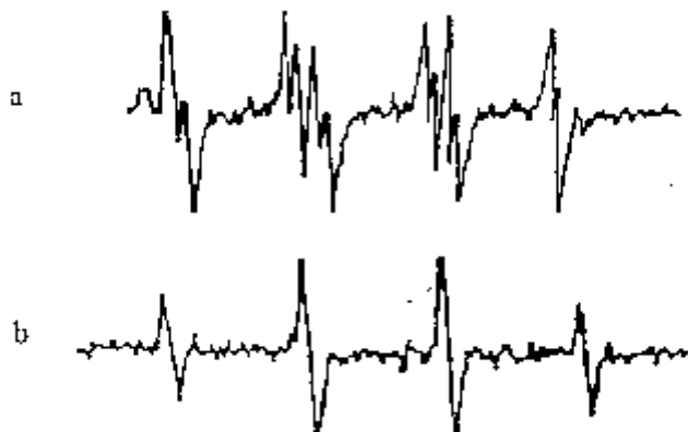
Wykres 4. Uchwycone spektra ESR DMPO. O 2 generowany przez napromieniowanie systemu ryboflawiny/EDTA (a) oraz wolne rodniki - OH wytwarzane w reakcji Fentona (b).
